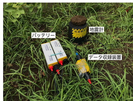
図 3 地震計の設置状況
